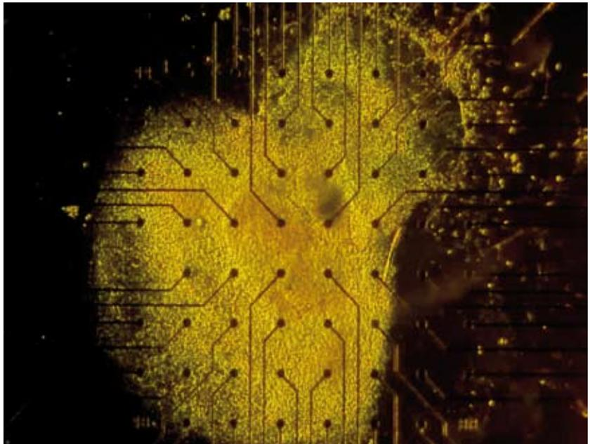
*Multi-Electrode-Array System (oben), mit dem die elektrische Aktivität von kardialen Zellaggregaten elektrophysiologisch gemessen werden können. Hierdurch können Nebenwirkungen von pharmakologischen Substanzen, z.B. Proarrhythmien, untersucht werden. Aus humanen ES Zellen differenziertes Herzmuskelgewebe auf einem Multi-Electrode Array Chip (unten, Abstand der Elektroden 0.2 mm, Durchmesser der Elektroden 0.03 mm)*
