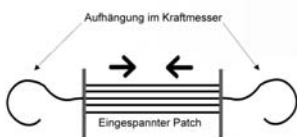
Prinzip der Kraftmessung im Modell
