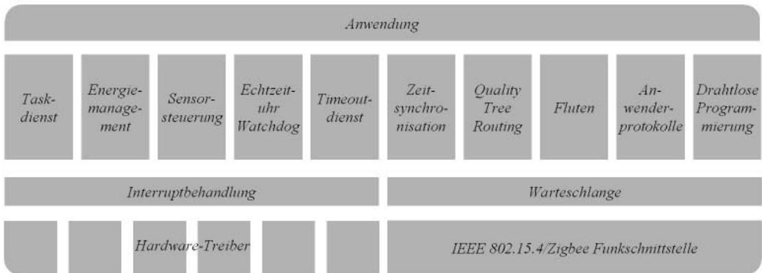
Abb. 7: Ein ebenfalls modulares Softwaresystem mit auswählbaren Komponenten ermöglicht die schnelle Entwicklung effizienter Anwendungen
