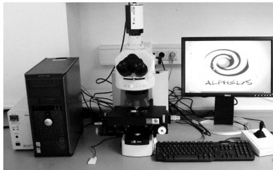
Abb. 2: SpotBrowser-System zur automatisierten Auswertung von TMAs bestehend aus Durchlichtmikroskop mit Tischmotorisierung, Digitalkamera und Computer mit entsprechender Software.
