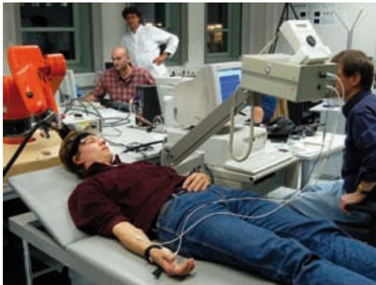
Abb. 3: Test des Prototypen in Zusammenarbeit mit Ärzten der Neurologie (Dr. Trillenber, rechts am PC) und Neurochirurgie (Dr. Giese, links stehend). Der Roboter fährt mit der Spule die Positionen an, die der Arzt am Computer vorgibt. Kopfbewegungen des Patienten können durch das Trackingsystem in Echtzeit ausgeglichen werden.
