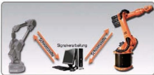
Abb. 8: Ein während der Entwicklungsphase genutzter Positionssensor (Messarm Microscribe G2X) ermöglicht eine Nachführung des Roboterwerkzeuges.
