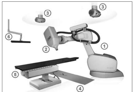
Abb. 2: Systemkomponenten des CyberKnife<sup>®</sup> Bestrahlungssystems: 1) Roboter, 2) Miniatur-Linearbeschleuniger (6 MeV), 3) Röntgenquellen, 4) Röntgenkameras (unterflur), 5) Behandlungscouch, 6) Infrarot-Trackingsystem.
