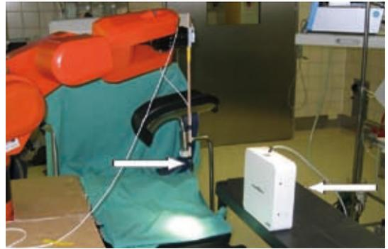
Abb. 4: Testung der Genauigkeit eines elektromagnetischen Trackingsystems (NDI Aurora) mit Sender und Empfänger (Pfeile) durch ein mechanisches Trackingssystem (Kuka-Roboter) in realer OP-Umgebung.
