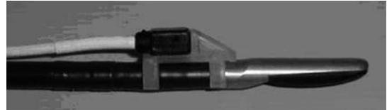
Abb 4b: Konnektion des Adapters an die abwinkelbare Spitze der laparoskopischen Ultraschallsonde (B&K Medical)
