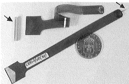
Abb. 5: Das speziell angefertigte Polyimid-Verbindungskabel zwischen einer Sonde U1 (Pfeil) und einem ZIF-Adapter der Firma Molex (Pfeil mit Doppellinie). Die schwedische Krone dient als Maßstab.
