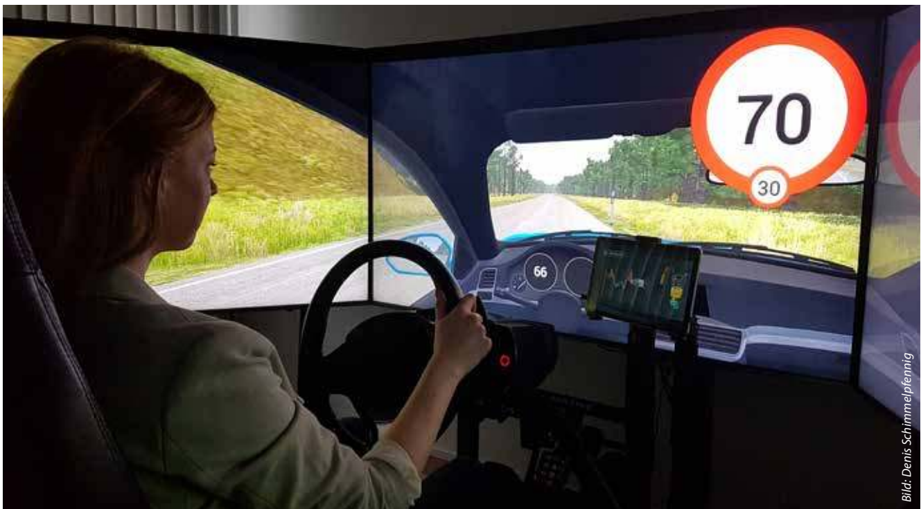
Freude am (digitalen) Fahren: Vivien Moll, wissenschaftliche Mitarbeiterin am IMIS, testet verschiedene Assistenzsysteme im Fahrsimulator.
